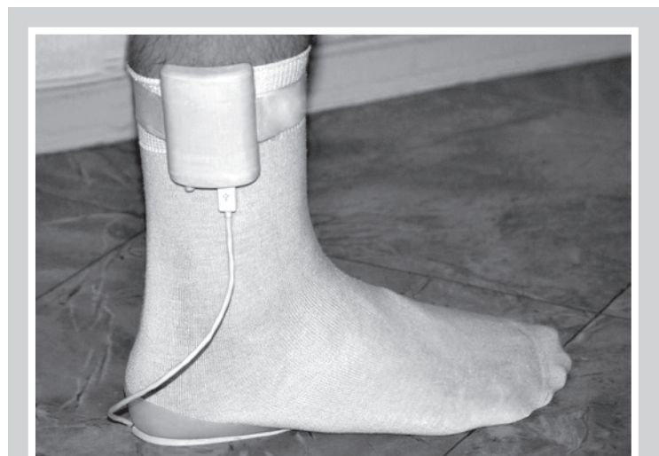
Рис. 2. Расположение датчика веса и крепление основного блока.
